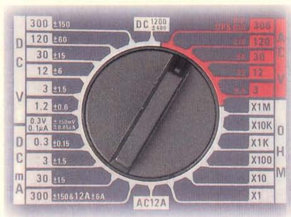
Figura 3.3. Posición para medir voltaje en corriente alterna
